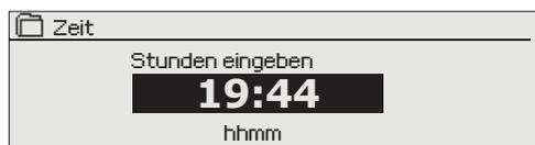
Es ist wichtig, dass Datum und Uhrzeit korrekt sind. Das Datum und die Uhrzeit werden z. B. in Zeitprogrammen (Wochen- und Urlaubskalender) sowie in der Alarmanzeige und im Routing verwendet. Die H21-Uhr berücksichtigt automatisch die Sommerzeit und die Schaltjahre. Die Uhr verfügt über ein Backup für Stromausfälle von mindestens einem Tag.
