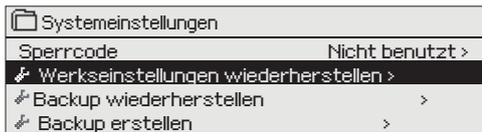
Wenn Sie die Werkseinstellungen wiederherstellen, verwendet der Regler die Steuerkreise, die vor dem Zurücksetzen auf die Werkseinstellungen verwendet wurden. Das Wiederherstellen der Werkseinstellungen erfolgt in den Systemeinstellungen durch langes Drücken der OK-Taste (Backup-Menü erscheint in den Systemeinstellungen).
