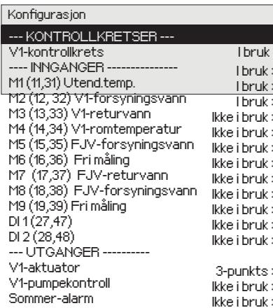
Minimum og maksimum alarmgrenser og inngangsforesinkelse kan defineres for hver **inngang**. Standardverdiene er: minimumsgrense -51 °C, maksimumsgrense 131 °C og inngangsforesinkelse 1 min.
