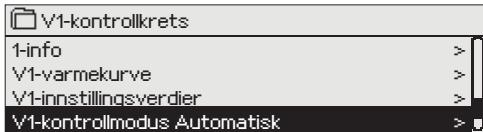
**Automatisk kontroll er modusen som brukes normalt. Du kan endre automatisk styring til manuell styring her, og kjøre ventilen til ønsket posisjon.**
