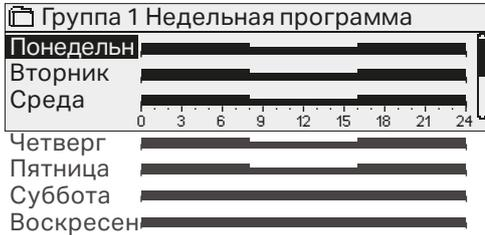
Данный пример показывает, что аварийные сигналы аварийной группы 1 всегда передаются следующему получателю. Аварийные сигналы передаются в рабочее время (пн-пт с 8 до 16 ч) одной бригаде, а в нерабочее время и на выходных – другой бригаде. Более подробная информация представлена в окне корректировки.
