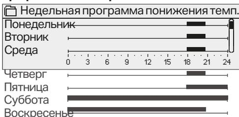
В составе недельных программ используются графические изображения в режиме общего вида и в режиме корректировки, содержащие данные о точном времени поступления новой команды управления. В графическом окне данные о понижении температуры в случае их отклонения от заданного температурного режима отображаются в виде балки.
