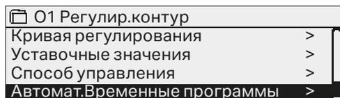
В контроллере A203 предусмотрена возможность включения в процесс регулирования недельных программ, программ особых дней и программ спецкалендаря. С помощью временных программ пользователь может включать режимы понижения температуры.
