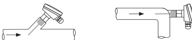
В месте установки датчика вода должна быть хорошо перемешанной. В системах регулирования контуров отопления датчик подающей воды устанавливается на расстоянии около 1 м, а в системах регулирования контуров хозяйственно-бытовой воды – на расстоянии около 0,5 м от точки смешения.
