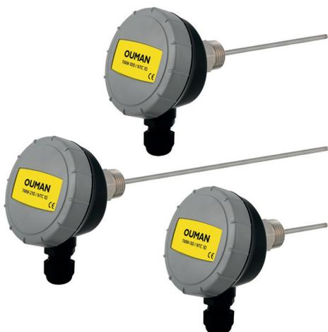
Датчики воды TMW предназначены для использования в качестве регулирующих устройств сетей отопления и хозяйственно-бытового водопровода. Датчики воды TMW предусматриваются длиной 50, 100 и 210 мм с погружной трубкой из нержавеющей стали диаметром 4 мм.
