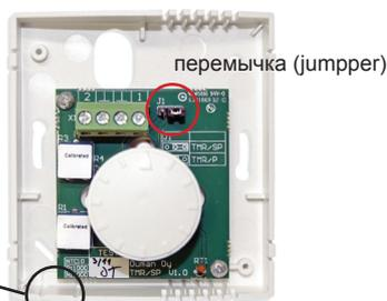
При накладном монтаже с креплением датчика напрямую к стене следует отсоединить от края корпуса заглушку отверстия для прокладки кабеля.
